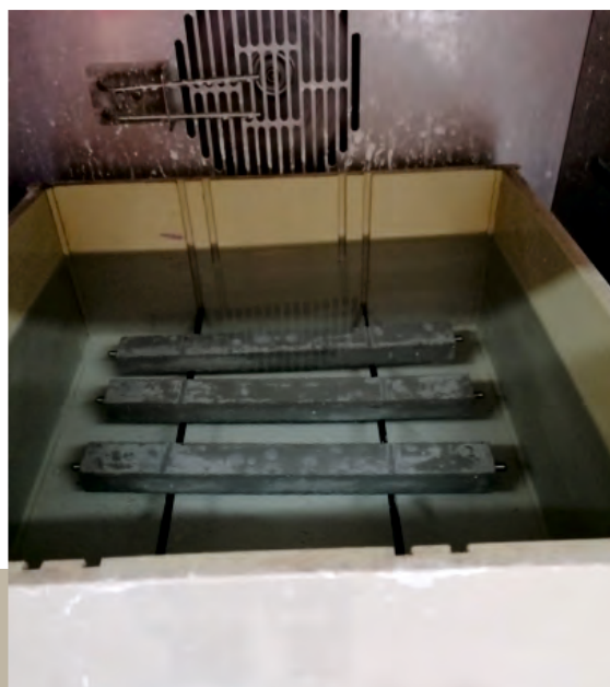
Beleczki zanurzone w roztworze NaOH w badaniu reaktywności alkalicznej
