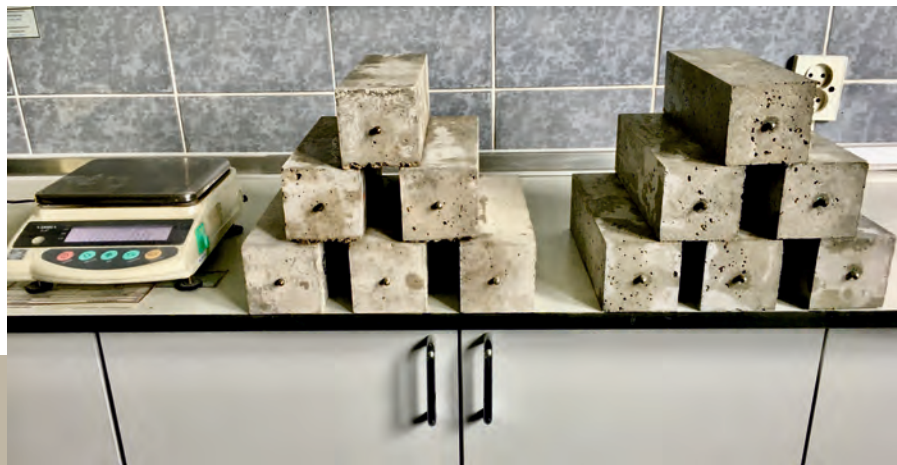
Beleczki do badania reaktywności alkalicznej wg ASTM C1293
