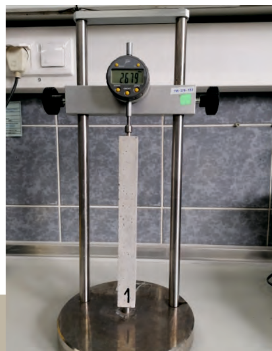
Przyrząd do badania zmian liniowych (np. w badaniu reaktywności alkalicznej)
